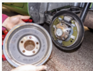
Po demontáži kola můžete preventivně zkontrolovat stav brzdového bubnu a obložení.
