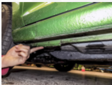
Zvedák umísťujte na místa k tomu určená, ne na střed vozu, ale vždy blíže ke kolu s defektem.
