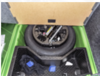
Náhradní kolo je společně s nástroji pro jeho výměnu zpravidla umístěno pod podlahou zavazadelníku.
