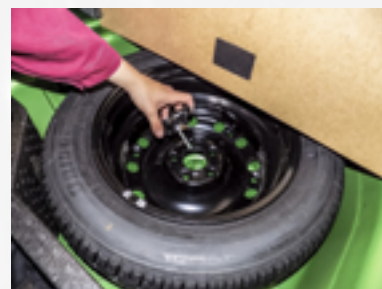
Kolo je v zavazadlovém prostoru připevněno jistící maticí.
