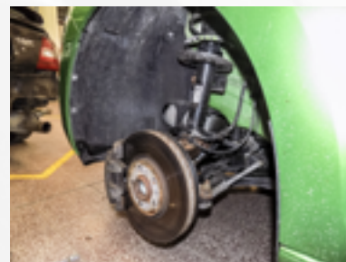
Po demontáži kola můžete preventivně zkontrolovat stav brzdových destiček a brzdového kotouče.
